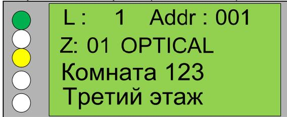
На примере показан адресный прибор номер 1 в АСШ 1, его логическая зона, тип и описание. В данном случае это фотозлектрический извещатель, расположенный в комнате 123 первого этажа.
