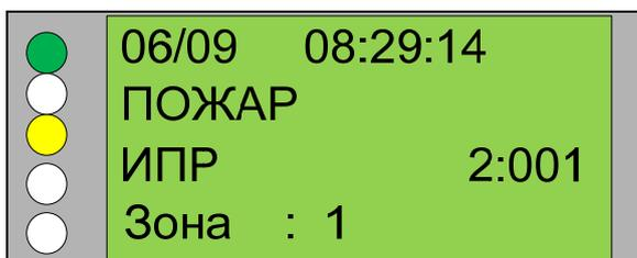
Для просмотра следующего сообщения нажмите кнопку «↓». При показе сообщения полученного с адресного прибора подключенного к АСШ на экране показывается вид события («ПОЖАР»), тип прибора и его адрес, а также логическая зона к которой он относится.
